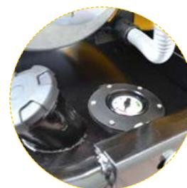
Zatvarač spremnika koji sprečava kapanje i veliki pokazivač razine goriva.
