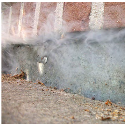
Prueba del sellado defectuoso de las conexiones murales por encima de un aparcamiento subterráneo
