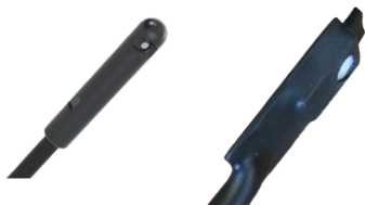
Fig. 8: Fuktighetsgivare (vänster) och VOC-givare (höger)
