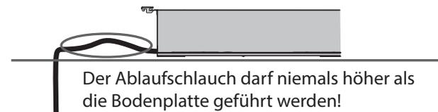
Der Ablaufschlauch darf niemals höher als die Bodenplatte geführt werden!
